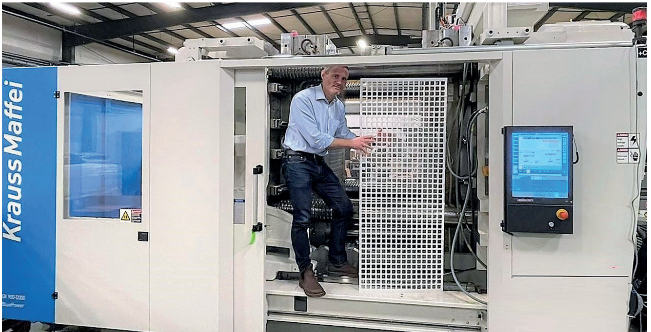
Sebastian Lotzin, Geschäftsführer der Barku-Niederlassung in den USA, mit Bodenrost (3250 g) in der 10000-kN-Spritzgießmaschine, auf der der Artikel produziert wird © Barku
